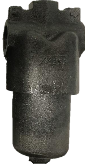
Şekil 4.23. Patlatılmış test numunesi (1,5 mm talaş kaldırılan numune 2)
