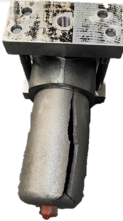
Şekil 4.37. Patlamış test numunesi (optimize edilmiş farklı üretim numune)
