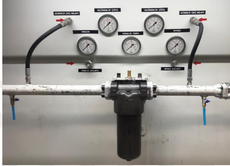
Şekil 4.38. 250 lt/dk filtre geçirgenlik testi bağlantısı
