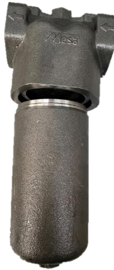
Şekil 4.34. Patlatılmış test numunesi (Optimizasyon edilmiş numune)
