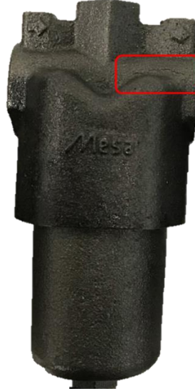
Şekil 4.21. Patlatılmış test numunesi (1,5mm talaş kaldırılan numune 1)
