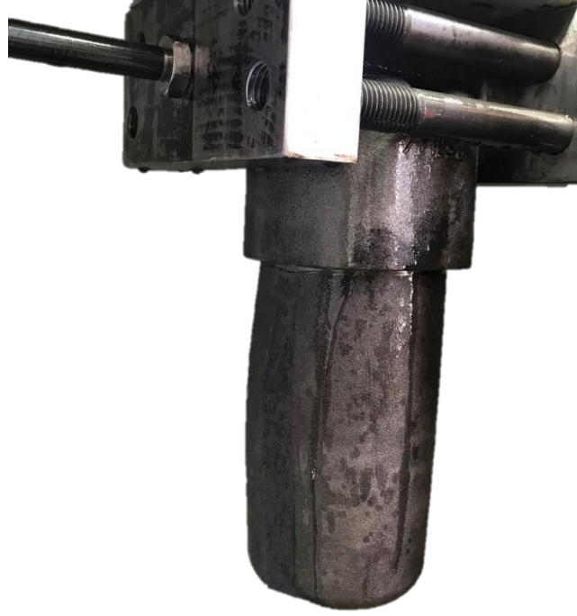
Şekil 4.30. 250 lt/dk filtresi patlatma bağlantısı
