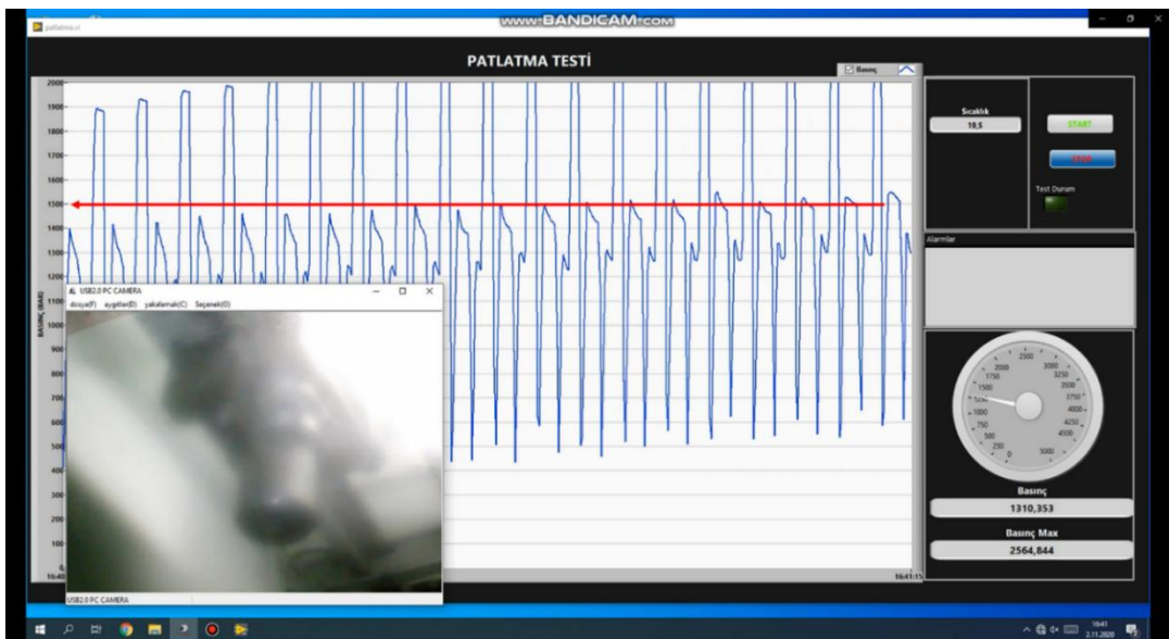
Şekil 4.22. Patlatma test grafiği (1,5 mm talaş kaldırılan numune 2)
