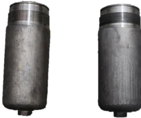
Şekil 4.26. 250 lt/dk filtre muhafazaları patlatma numuneleri
