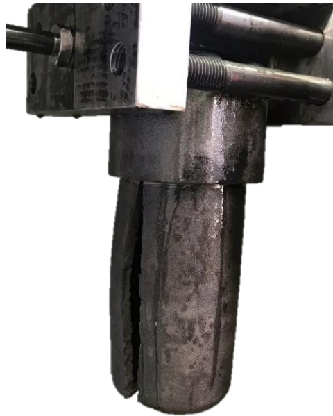
Şekil 4.32. Patlatılmış test numunesi (Optimizasyon yapılmamış test numunesi)
