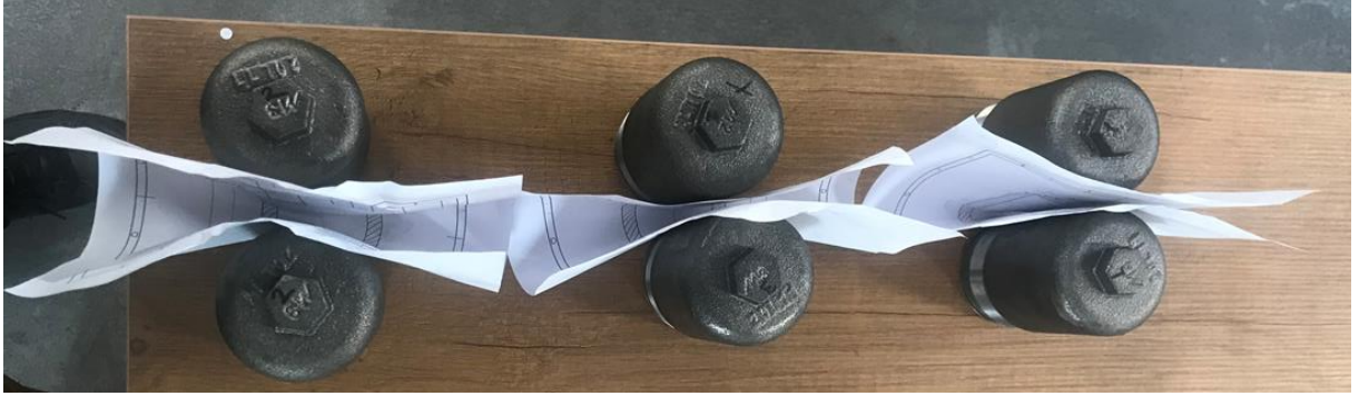
Şekil 4.13. 40 lt/dk filtre muhafazası farklı ölçülerde test numuneleri
