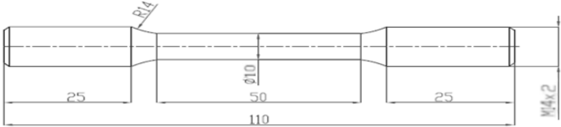
Şekil 3.8. EN 1563’e göre çekme testi numunesi [12]
