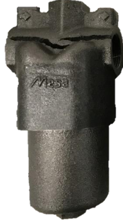
Şekil 4.19. Patlatılmış test numunesi (ilk muhafaza)
