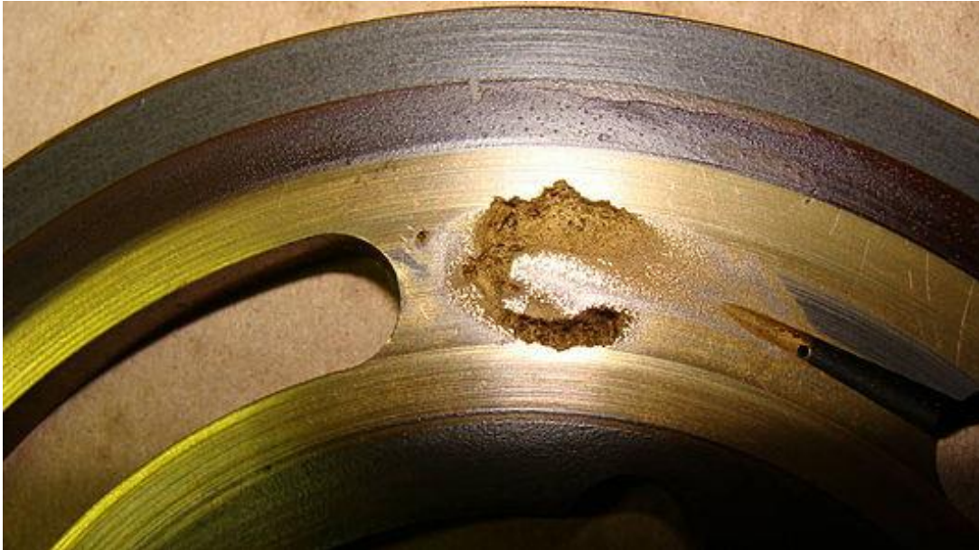
Şekil 1.13. Pompa yüzeyinde kavitezyonu sonucu oluşan delik [11]
