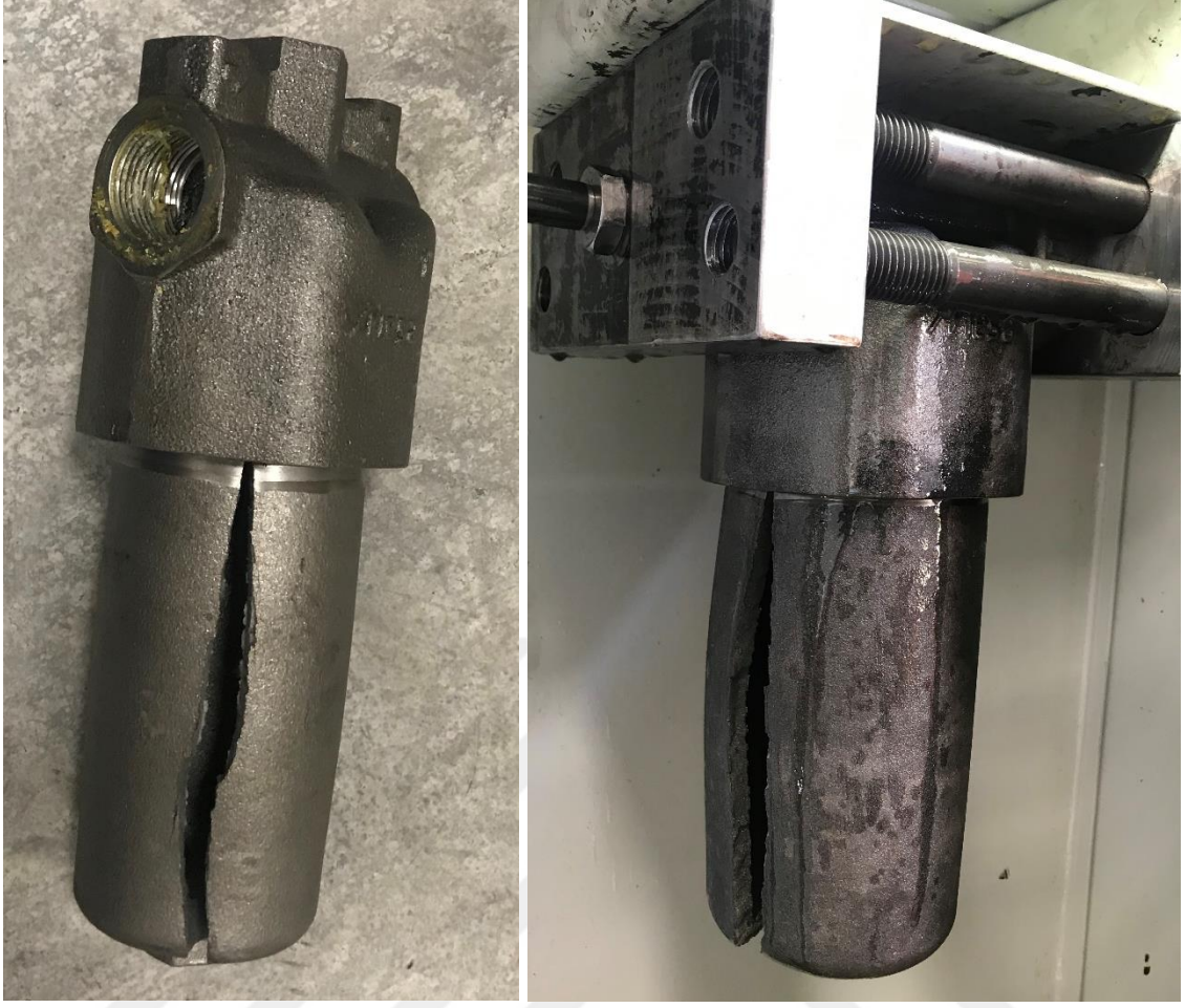
Şekil 4.16. Patlatılmış filtre modelleri
