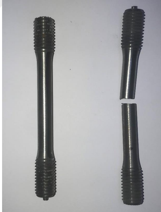
Şekil 4.10. Çekme testi numunesi ve çekilen numune
